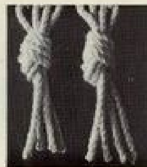
MOUCHET (Noeud simple) Former une boucle, passer les bouts à travers et serrer.
