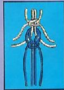
Montaje de hilos con anillo de unión B. Se hace un nudo en el punto de unión y se sujetan los hilos con un cable que se le hace un nudo en el punto de unión.
