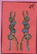
Nudo de traza sencilla en el crucero Se entrelazan los hilos cruzados con 3 o 4 vueltas en el hilo y luego se cruzan los tramos de hilo. Se nota a simple vista que los hilos se cruzan.
