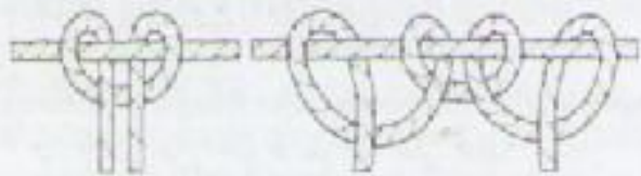
Montage d'un double-nœud à agrafe تركيب عقدة مزدوجة برأس مشبك
